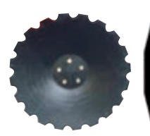
De diamètre 520 mm ou 573 mm, coniques pour garder le meilleur angle de coupe selon l'usure, petites crénelures pour obtenir un fond de profil plat. Les disques sont traités 215 kg mm 2 pour assurer une plus grande longévité.
