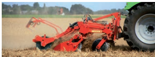
Le Compactiller, de 3 à 6 m porté, est disponible en version fixe ou repliable. Il est équipé de disques de 573 x 6 mm.
