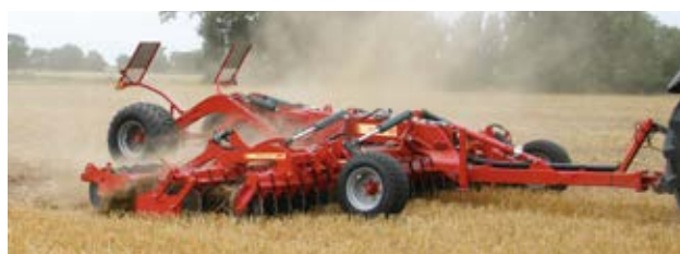
Le Compactiller LT traîné, version semi-portée du Compactiller L disponible de 4 à 6 m, également équipé de disques de 520 x 5 mm.
