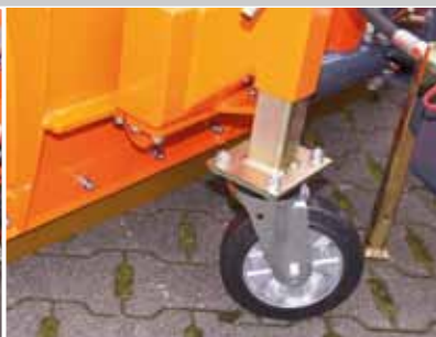
Roues de soutien et de guidage stables
