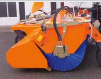
Moteur intérieur et l'optimisation de l'angle de balayage
