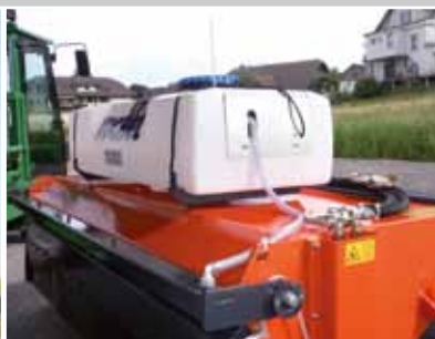
Système de pulvérisateur avec réservoir d'eau 100 / 200 litres
