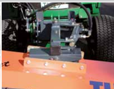
Double compensateur de niveau incl. orientation latérale hydraulique
