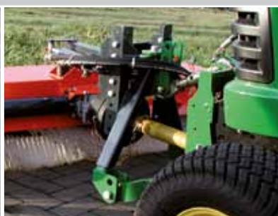
Entraînement mécanique de 540 jusqu'à 2100 tr/min
