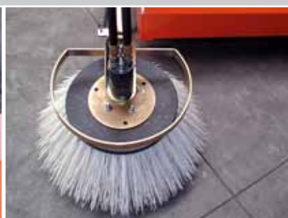
Brosse latérale actionnée hydrauliquement
