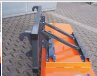
Système d'attelage pour valets de ferme
