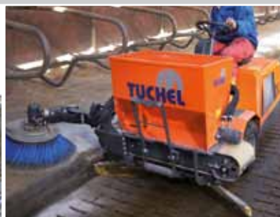
Racler des caillebotis – nettoyer et pailler des logettes tout dans un passage
