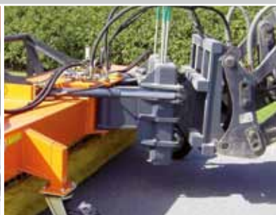
Guidage optimal au sol par le système de compensateur 3-D
