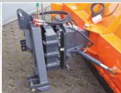
Systèmes d'attelage pour des divers véhicules-porteurs
