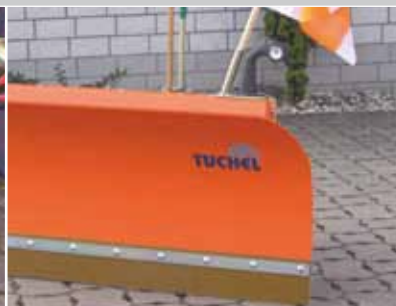
Bords arrondis sur les côtés et en haut, pour une grande stabilité
