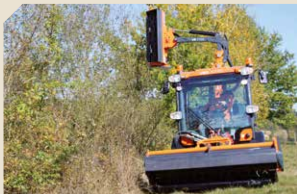
Quand cela est nécessaire, l'épareuse peut dégager une haie. La portée verticale est de 4.35.
