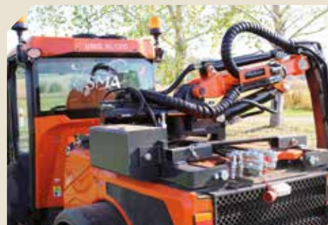
Quand cela est nécessaire, l'épareuse peut dégager une haie. La portée verticale est de 4.35.
