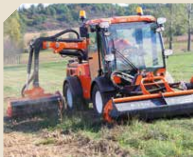
Quand cela est nécessaire, l'épareuse peut dégager une haie. La portée verticale est de 4.35.
