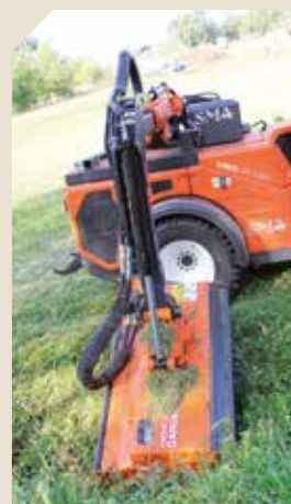
Quand cela est nécessaire, l'épareuse peut dégager une haie. La portée verticale est de 4.35.
