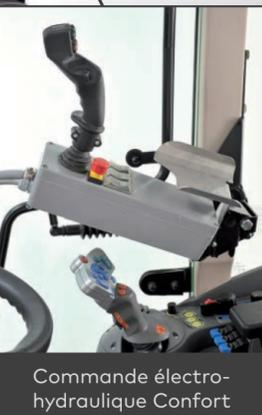
Commande électro-hydraulique Confort
