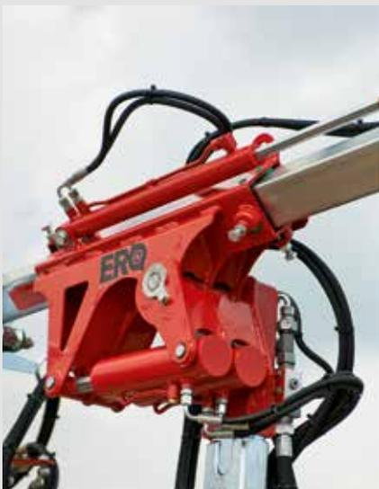
Cinématique en Z, construction renforcée avec 2 vérins, obligatoire pour la rogneuse ERO ELITE unilatérale 1 rang complet à partir d'une longueur de coupe de 185 cm.
