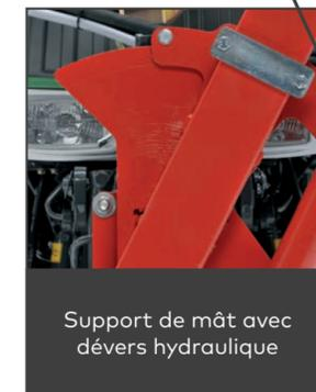
Support de mât avec dévers hydraulique
