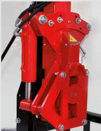
Support pour mât de relevage avec dévers hydraulique (54°)
