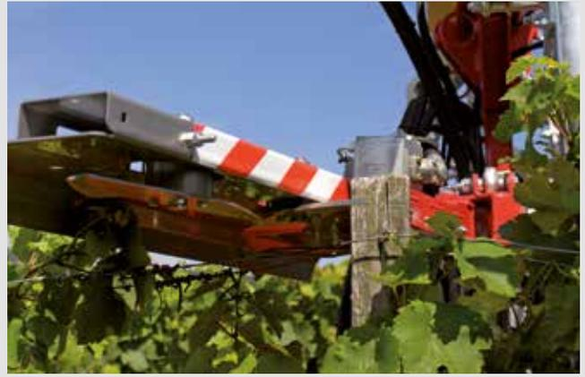
Sécurité d'effacement sur les barres de coupe horizontale et verticale et retour automatique commandés par ressort à gaz
