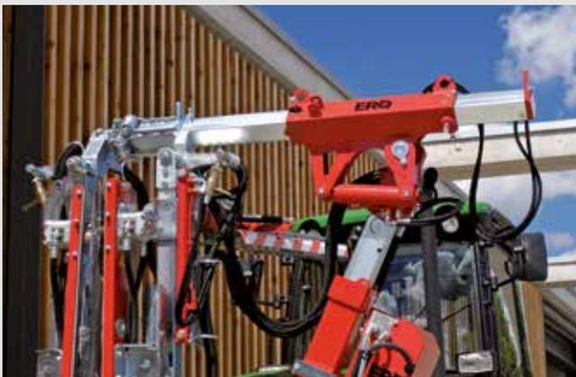
Cinématique en Z pour déplacement du module de coupe devant le tracteur. Dispositif nécessaire pour sortir des rangs en fausse ligne, assure une meilleure visibilité lors des déplacements sur route.
