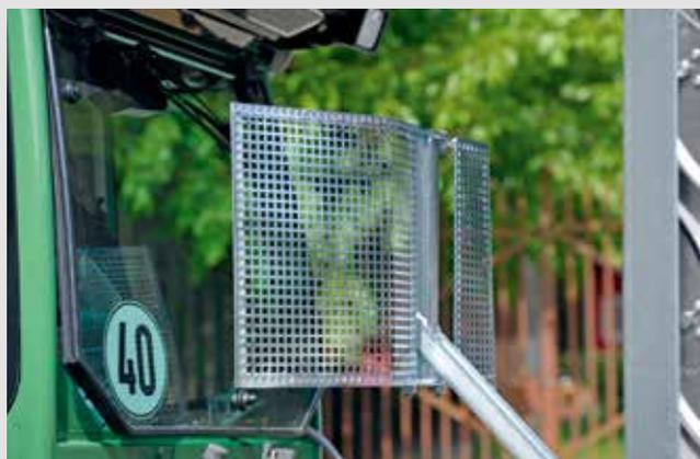
Protection anti-coupure pour rogneuse avec boogie
