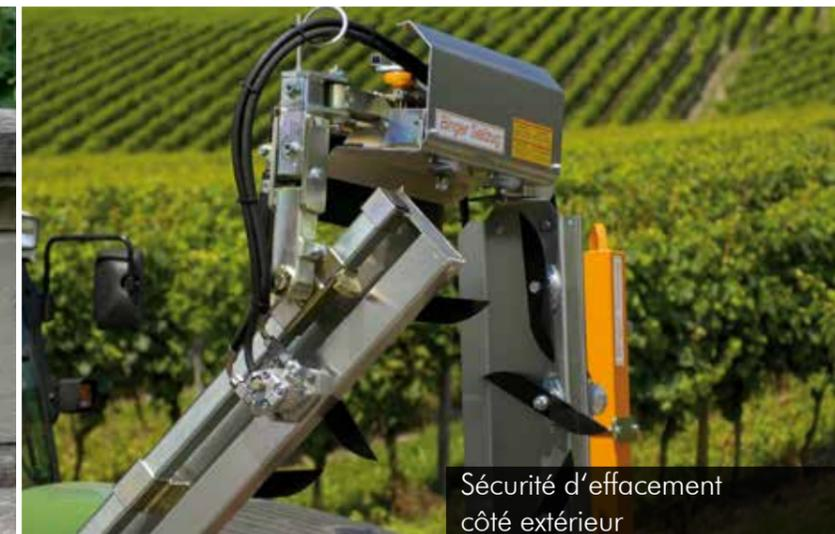
Les modèles AC 3, AU 3 et AU 3V proposent une largeur de coupe à réglage manuel. Les modèles AU disposent en série du réglage d'angle et de la sécurité d'effacement sur les barres de coupe extérieures.
