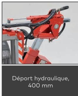
Déport hydraulique, 400 mm
