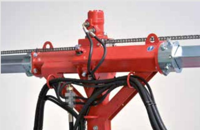
Écartement hydraulique des modules de coupe: les pièces de tête disponibles en plusieurs dimensions permettent de traiter des rangs larges de 1,38 m à 3,50 m.
