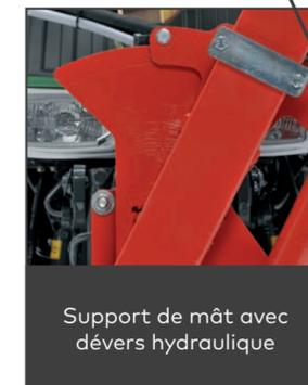
Support de mât avec dévers hydraulique
