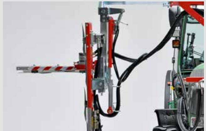
Réglage hydraulique de la hauteur de coupe horizontale (40 cm)
