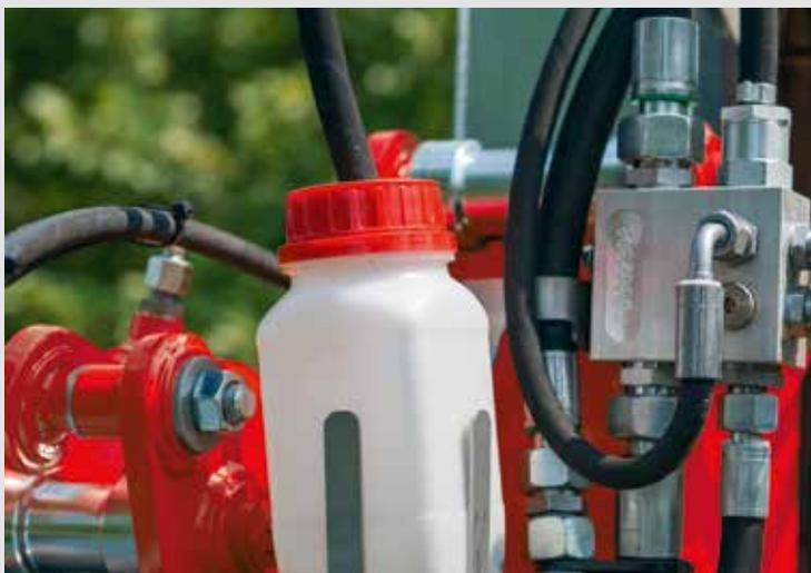
Limiteur de pression 6 bars pour protéger le moteur en cas de pic de pression au retour. Protège également en cas d'erreur de manipulation ou d'utilisation inappropriée.
