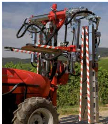
Les barres de coupe entièrement rétractables et l'écimeuse repliable sécurisent les déplacements sur route (équipement de série).
