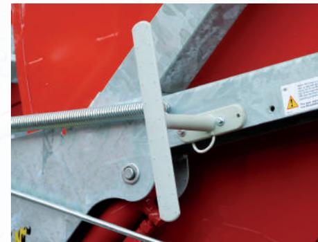
Antenne amplifiée pour module GSM.
