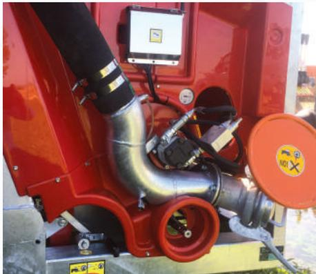
Enroulement du tuyau avec moteur diesel YANMAR L70 sans turbine, complet de transmission hydrostatique avec moteur hydraulique sur réducteur, valve compensatrice de vitesse, double pompe hydraulique pour alimentation des services, qu'on peut accoupler à des programmeurs électroniques RM. Le produit en option remplace l'enroulement à turbine (seulement pour les modèles XJ).
