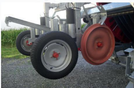
Chariot avec deux roues pneumatiques et deux roues en fonte
