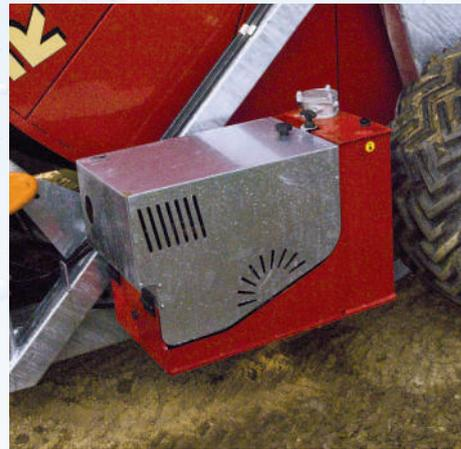
Unité de commande actionnée par un moteur à 4 temps HONDA GX160 Hp 5,5 pour des services oléodynamiques.
