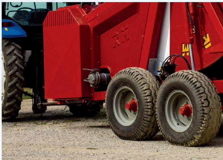
Toutes les machines de la série XJ et XJM dotées d'un double essieu avec roues isodiamétriques disposent du basculeur asymétrique; cette solution permet une forte réduction de l'effort de traction sur des terrains difficiles qui, accompagnée d'un encombrement transversal réduit, garantit également une meilleure répartition du poids en phases de direction rendant la machine plus maniable qu'avec un simple essieu.
