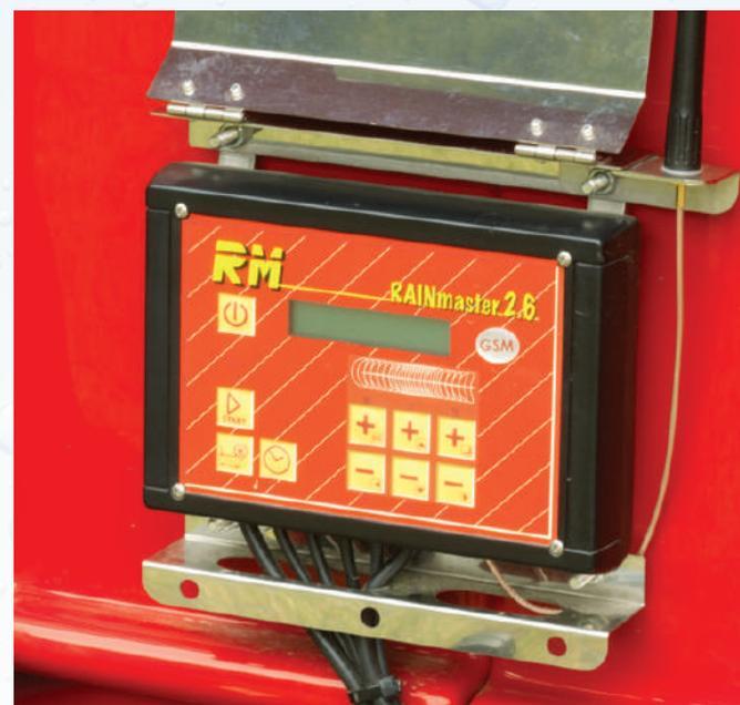
Les programmeurs électroniques RM ont été conçus pour une parfaite intégration sur l'enrouleur donnant la priorité à la simplicité d'utilisation et **avec un écran intuitif et multilingue**, il peut être facilement exclu sans interrompre le cycle d'irrigation de la machine pour passer du fonctionnement automatique à celui manuel.
