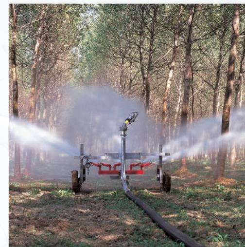
Dispositif pour irrigation sous-frondaison.
