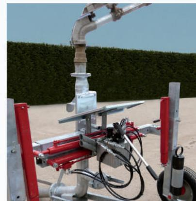
Réglage hydraulique largeur chariot et enregistrement mécanique de la hauteur des roues
