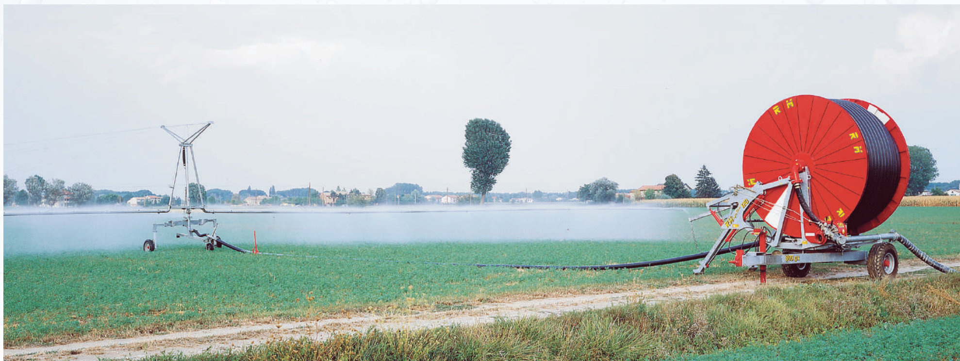
Rampe d'arrosage en acier avec structure de 50 mètres montée sur 890 Gx
