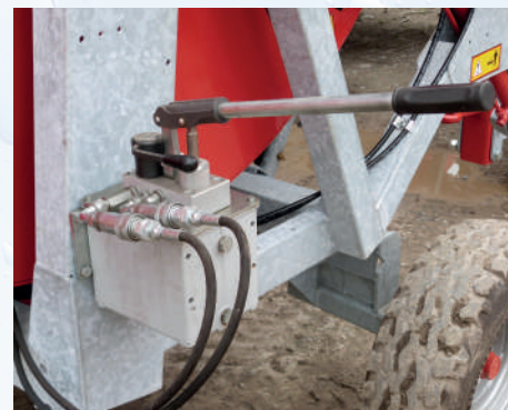
Pompe manuelle pour actionnement bequille arrières et soulèvement chariot ( optionnel pour les modèles 570 Gx Evo, 581 Gx Evo, 690 Gx, 790 Gx).
