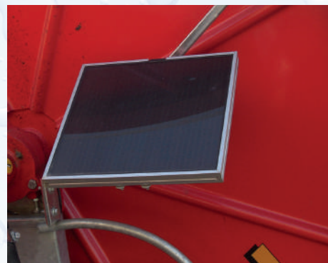
Panneau solaire pour alimentation des appareils électroniques
