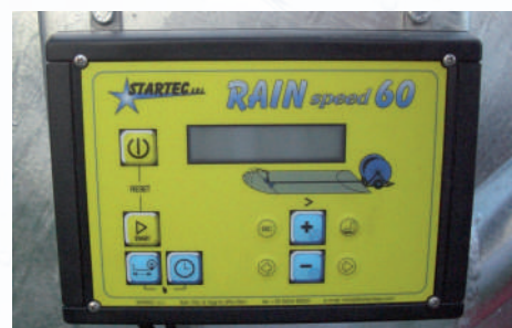
Compte mètres digital Speed 60 pour la mesure de la vitesse de enroulement
