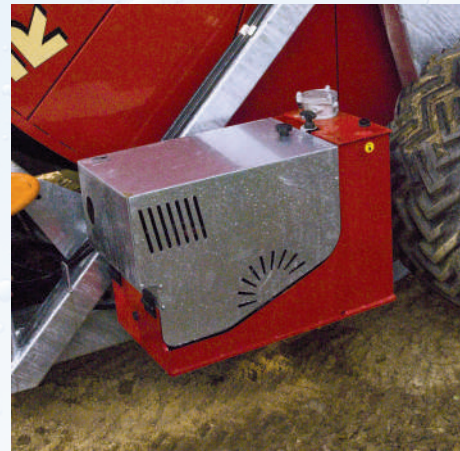
Unité de commande actionnée par un moteur à 4 temps HONDA GX160 Hp 5,5 pour des services oléodynamiques.
