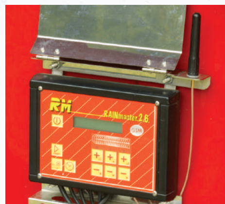
Programmateur RM modèle RainMaster 2.6 (avec antenne et module GSM optionnel intégré)
