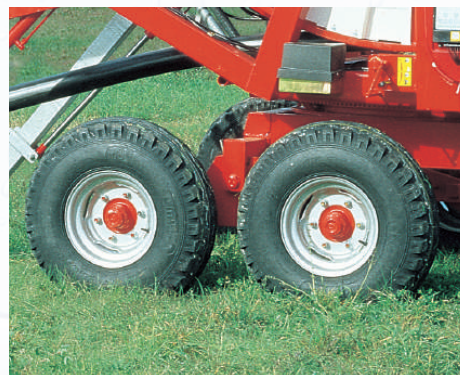
Double essieu sur boggie asymétrique (optionnel pour mod.690 Gx, 790 Gx, 890 Gx, 890 Gx Evo).
