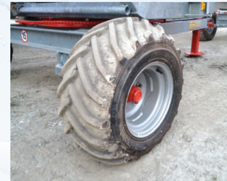
Pneumatique basse pression pour mod 581 Gx Evo mesure 26/12.00-12
