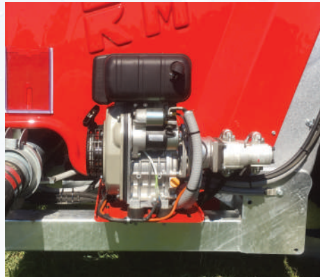
Unité de commande actionnée par un moteur à 4 temps HONDA GX160 Hp 5,5 pour des services oléodynamiques.
