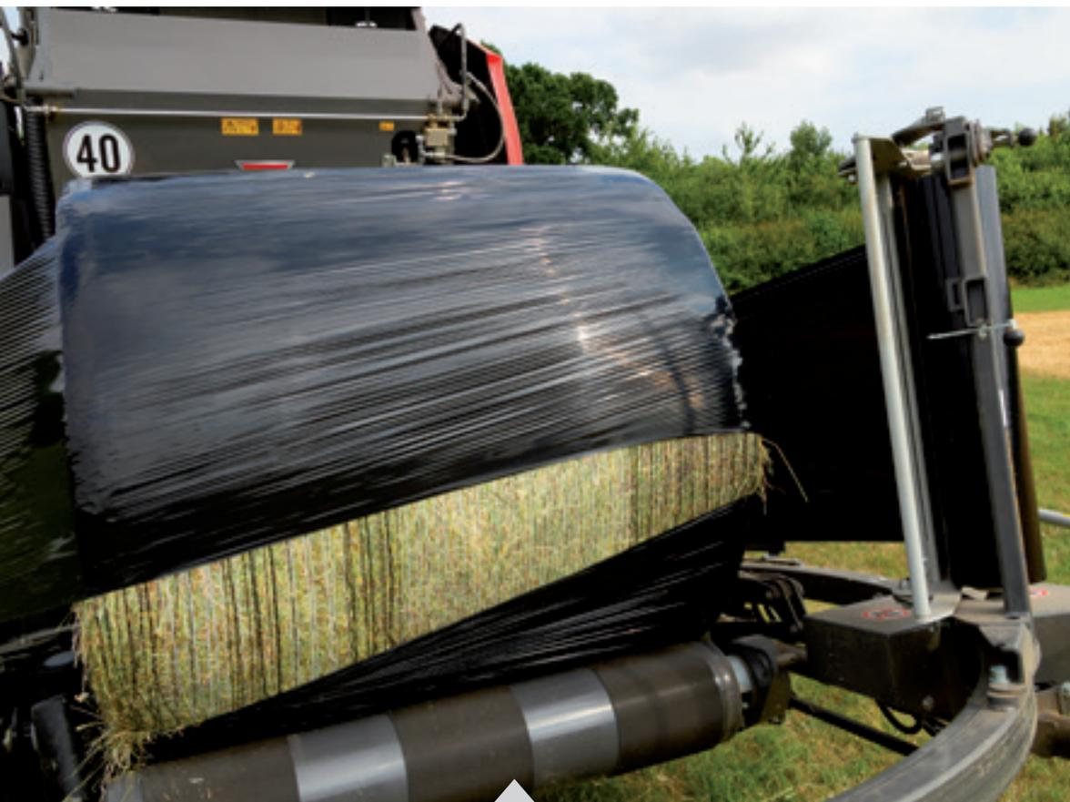
La table d'enrubannage entraînée hydrauliquement se compose de deux rouleaux et de trois courroies sans fin installés sur un châssis soudé pour plus de durabilité. Un capteur situé sous la courroie centrale permet de commencer l'enrubannage uniquement lorsque la balle est complètement positionnée sur la table, tandis que quatre grands rouleaux de support latéral maintiennent la balle centrée pendant l'enrubannage.
