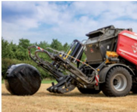
Afin d'assurer un déchargement fluide des balles, la table d'enrubannage est rabaisée près du sol, ce qui minimise la vitesse de dépose de la balle, prévient l'endommagement du film et maintient la forme idéale de la balle. Un retourneur de balles en option empêche les balles de rouler et facilite le chargement sur la remorque. L'opérateur peut aussi choisir entre les modes de déchargement automatique et manuel.
