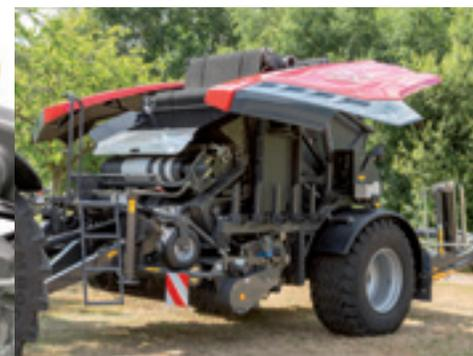
Douze supports de rouleaux de film sont idéalement situés à une hauteur confortable de chaque côté de la presse à balles ainsi que deux rouleaux supplémentaires sur l'enrubanneuse, pour une productivité accrue.
