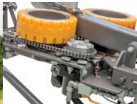
Le carrousel d'enrubannage est entraîné par un ensemble de deux rouleaux en caoutchouc qui garantit une adhérence optimale, évite les glissements et réduit le bruit.
