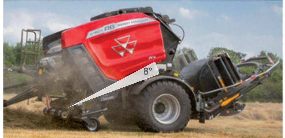
L'angle du flux du fourrage du nouveau combiné Protec est réduit, ce qui permet de limiter la hauteur hors tout de la presse et ainsi d'améliorer la stabilité, pour des opérations en pente plus sûres et plus rapides. Cela permet aussi d'améliorer l'alimentation et ainsi d'optimiser le débit de récolte et de minimiser le risque de bourrage.
