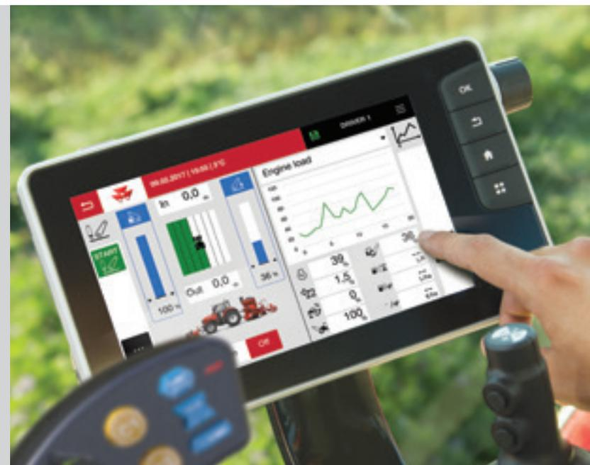
La presse à balles MF 4160V Protec peut intégrer une connexion ISOBUS pour utiliser les terminaux du tracteur.
