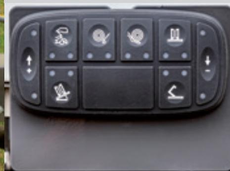
Un panneau de contrôle externe situé à l'arrière de la presse à balles permet de contrôler la porte, le carrousel et la table d'enrubannage ainsi que les pinces film, ce qui facilite les changements de rouleaux, la maintenance et le nettoyage.
