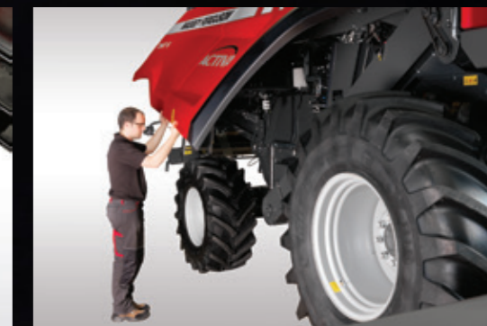
Panneaux de grandes dimensions avec éclairage facilitant l'accès pour les contrôles
