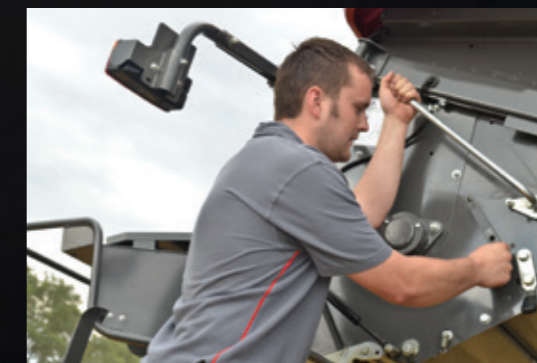
Passage facile du broyage à la formation d'andains pour le pressage
