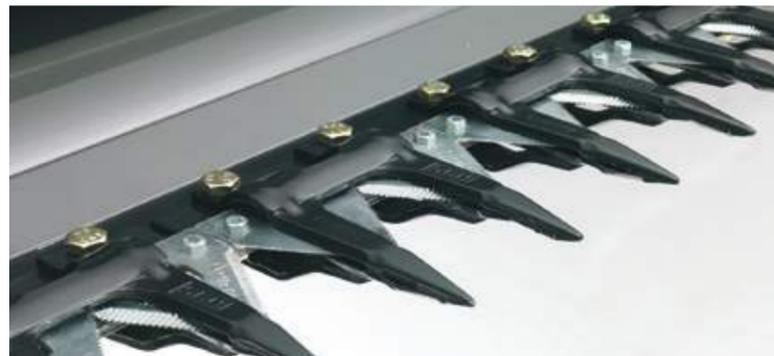
Avec 1 254 coups par minute, le lamier Schumacher est le plus performant du marché. Autonettoyant et constamment aiguisé, il se charge de la coupe de la récolte sans interruption et même dans les conditions les plus difficiles.
