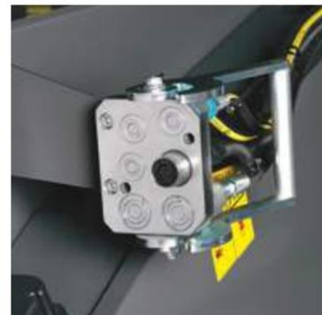
Multicoupleur combiné de série pour une dépose de table rapide.\*
