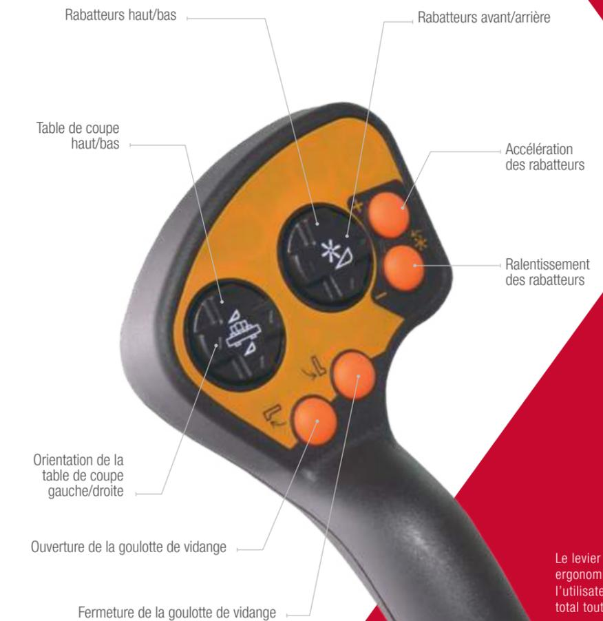
Le levier multifonction ergonomique apporte à l'utilisateur un contrôle total tout en confort.
