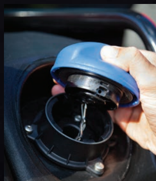
Le réservoir d'AdBlue® a été minutieusement positionné afin d'améliorer l'isolation contre le froid ou la chaleur. Le remplissage des deux réservoirs est sûr et pratique.
