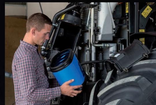
La conception du système de refroidissement garantit une facilité d'accès, de nettoyage et d'entretien. 90 % de la poussière est éliminée grâce au système d'aspiration du ventilateur de refroidissement. Le filtre à air moteur est également très facile d'accès pour le nettoyage.
