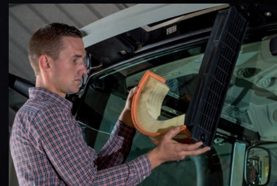
Le filtre à air de la cabine peut être retiré facilement pour le nettoyer.
