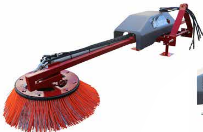
Modèle présenté avec un attelage 3 points pour travail à l'arrière droit ou à l'avant gauche du tracteur
