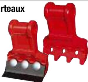
En raison de leur géométrie spéciale et de leur poids propre élevé de 4,6 kg, les doubles marteaux génèrent un effet d'aspiration favorable ainsi qu'un excellent résultat de coupe. Une lame herbe ou une lame bois peut être vissée au choix sur le porte-marteau. L'utilisation des lames interchangeables est très économique.
