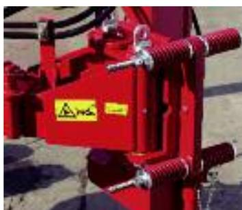
Dispositif de sécurité stable comme protection contre les collisions et les obstacles.
