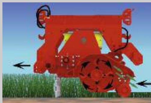
Selon utilisation, les broyeur à marteaux humus sont équipés avec des couteaux en Y ou avec des marteaux :
