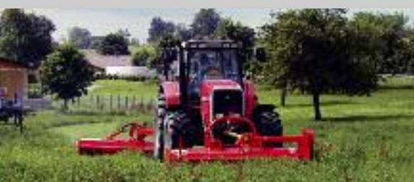
Rendement séduisant dans l'emploi dans les grands espaces : combiné avec un broyeur frontal, on obtient une largeur totale pouvant atteindre 5,40 m.
