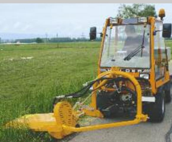
Montage frontal seulement possible avec entraînement hydraulique et une vitesse de rotation de 540 t/min.
