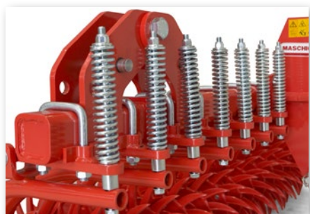
Pression au sol réglable mécaniquement par ressorts
