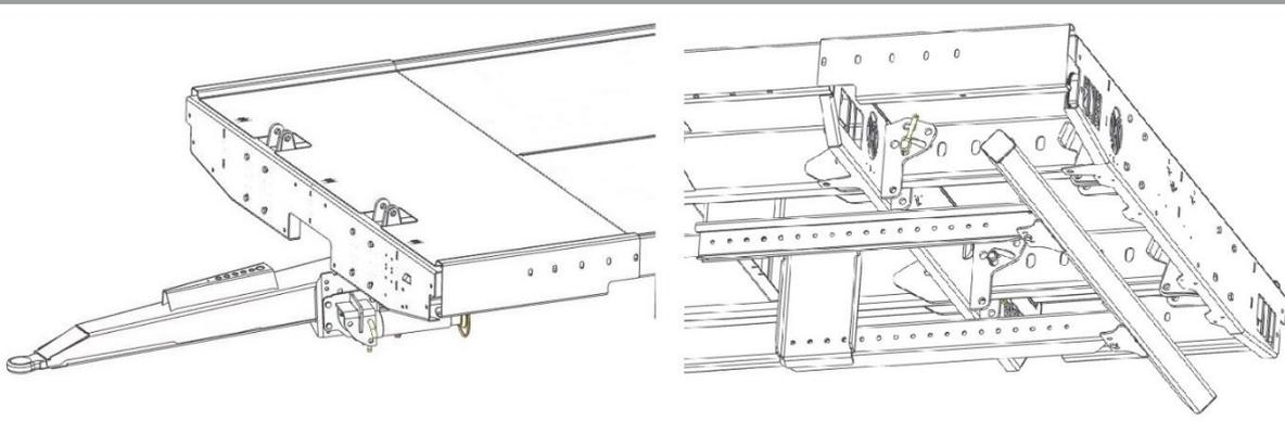
Une rallonge avant de 0.75m et une rallonge arrière de 0.75m réglable tous les 12cm pour augmenter la longueur de plancher du plateau jusqu'à 1m50
