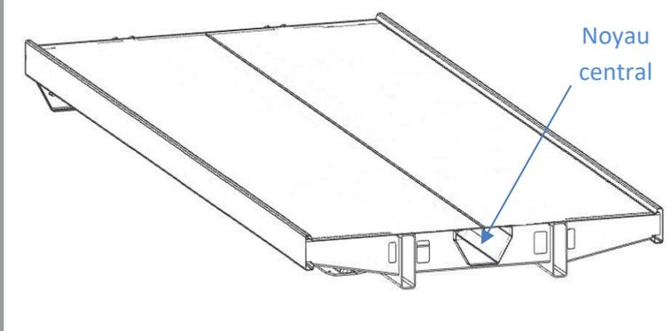
**Un noyau central pour renforcer le centre du plateau et éviter une torsion.**
