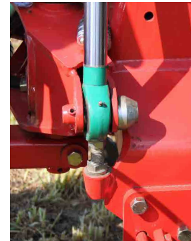
Simplicité de réglage: butée d'aplomb indépendante droite / gauche
