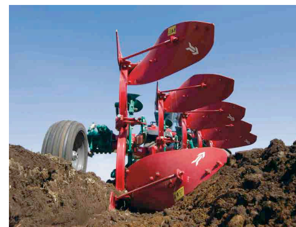
Profil du versoir N°28 Profondeur de travail : 26 cm, en bas : 30 cm, largeur 73 cm
