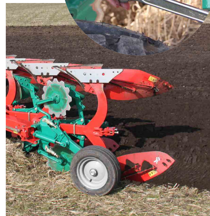
Réglage simple et rapide de la profondeur de travail à l'aide de vis en Y
