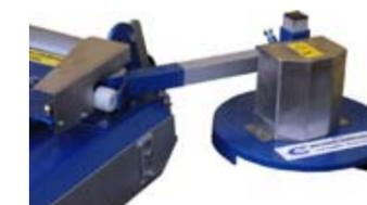
Nous adaptons également une tête escamotable sur nos gyrobroyeurs pour permettre la tonte sous la vigne.
