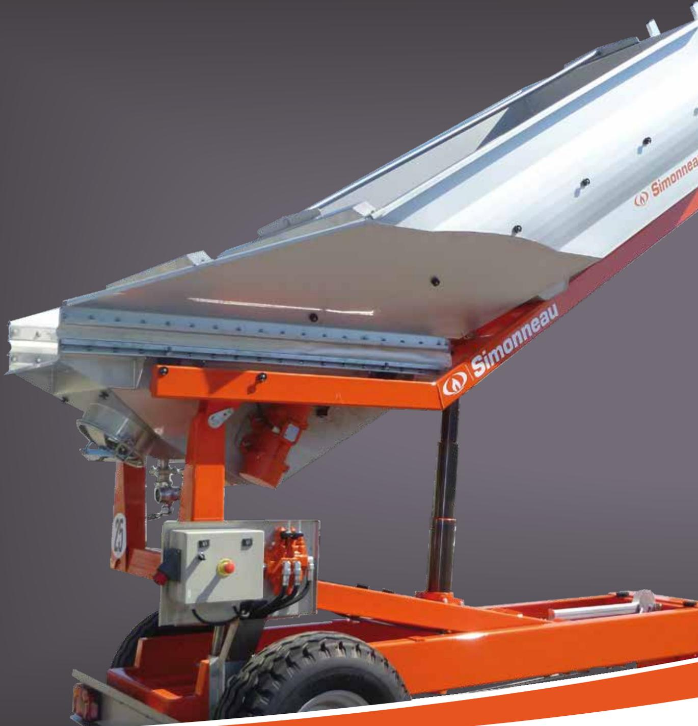
La remorque basculante BV est équipée d'un fond de bec vibrant qui vient réguler le déchargement de la vendange tout en limitant les risques d'écrasement et de trituration des baies.
