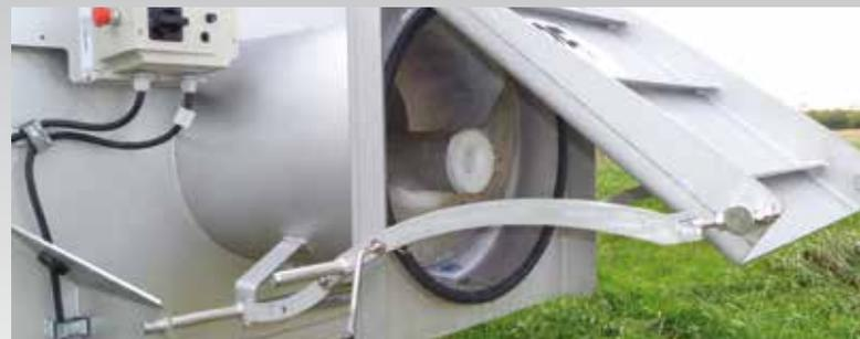
Système d'étanchéité exclusif auto-vérouillant de la porte.
