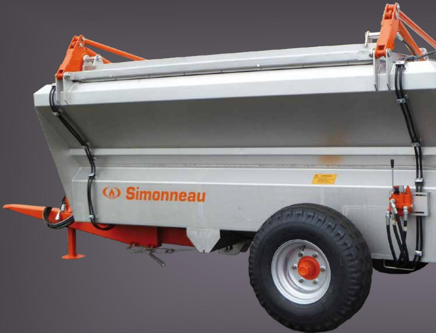
Les angles des caisses de nos bennes à sortie directe ont un profil anti-voûte, favorisant l'écoulement continu de la vendange sur la vis. Nos tunnels sont recouverts de téflon et leurs sorties sont élargies (+ 10 cm de diamètre par rapport à la vis) pour éviter toute trituration excessive de la vendange.
