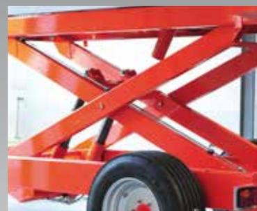
Châssis Élévateur en X
