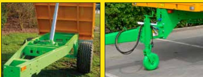
Les modèles double essieux, disponibles à partir de 5 T sont équipés d'un bogie Roll-Over permettant de compenser les irrégularités du sol, d'augmenter la force de traction et le confort de roulage. Plus d'info à la page 8.
