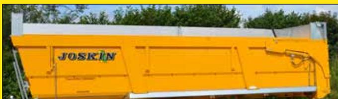
Combinaison de rehausSES en alu et d'une rehausse hydraulique en acier (50 cm)
