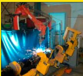
Robot de soudure
