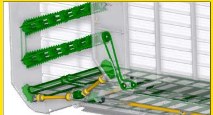
Les DRAKKAR et Silo-SPACE peuvent être équipés d'un double volet de recouvrement (DUO-COVER). Le recouvrement se fait à l'aide de 2 volets en filet flexible. Les filets s'appuient parfaitement sur le dôme avec une grande résistance pour assurer un transport sans perte.
