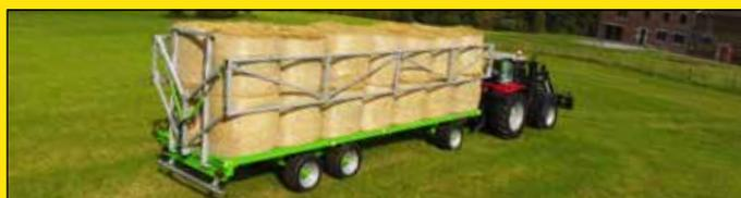
En option sur les modèles 10000T15 et 10000T20, des barrières latérales hydrauliques (2 SE) apportent sécurité et rapidité d'utilisation
