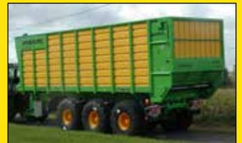
Le Silo-CARGO peut également être équipé de rouleaux-doseurs entraînés mécaniquement par un cardan traversant le châssis CARGO. Des rehausses latérales hydrauliques sont disponibles en option pour augmenter le volume de charge.
