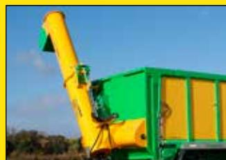
Un système de transbordement peut être monté sur la porte arrière du DRAKKAR. Deux vis, l'une horizontale sur toute la largeur de la caisse et l'autre verticale, entraînent la matière avec un débit de 450 t/h. Une seconde porte est fournie pour une utilisation sans la vis.
