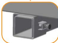
Il est fortement recommandé une poutre de renfort sous le bac du râtelier (en option). Les poutres permettent d'augmenter la résistance du bac et elles sont préconisées lors d'utilisation de fourrage de type enrubannage
