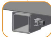
Poutre de renfort sous le bac du râtelier de série. Les poutres permettent d'augmenter la résistance du bac et elles sont préconisées lors d'utilisation de fourrage de type enrubannage
