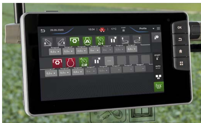
LA GESTION DES MANŒUVRES EN FOURRIÈRE est disponible depuis le Datatronic 5 sur la version Exclusive (en option sur la version Efficient)...
