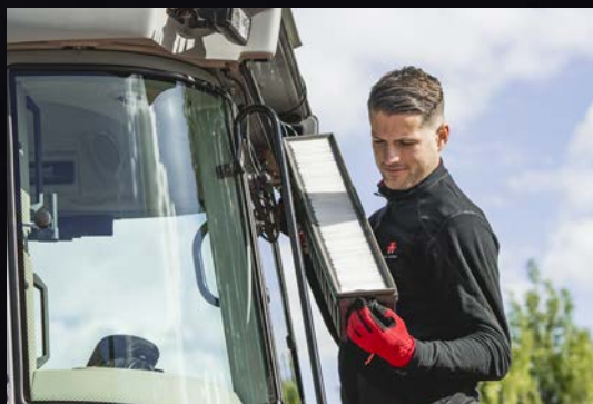
Accès facile pour retirer et nettoyer le filtre à air de la cabine.
